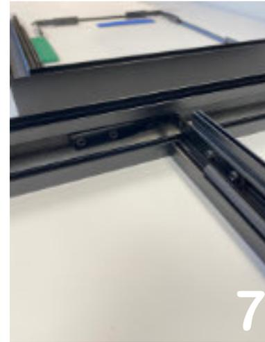
Pour le montage du "cadre" commencez par insérer les montants puis les cotés verticaux en faisant coulisser les équerres dans le profil
