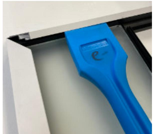
La façade est assez simple à poser mais il faudra utiliser un démonte-parcloses pour retirer les panneaux si nécessaire.
